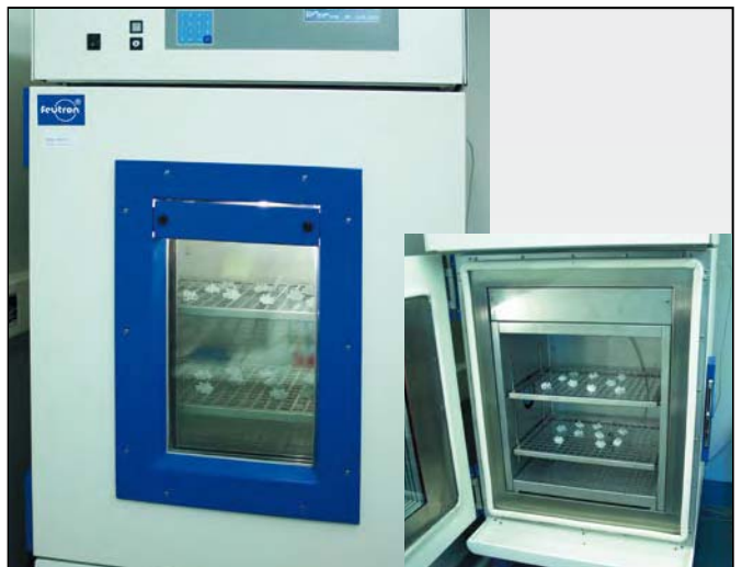
Klimakammer für Langzeituntersuchungen auf Temperatur und Feuchtigkeit Climate chamber for long-term investigation of temperature and humidity
