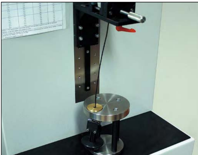
Drehprüfgerät zur Beurteilung einer zuverlässigen Verbindung test device for testing the connection with a spinning wire
